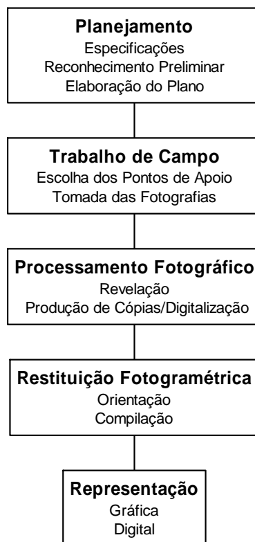
Figura 1 – Esquema das Atividades de um Levantamento Fotogramétrico Fonte: Adaptado de JAUREGUI & JAUREGUI (2000)
